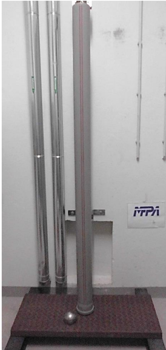
Abbildung 6. Prüfaufbau Schlagfestigkeit (Auflager, Prüfteil, Fallgewicht, Fallrohr)
