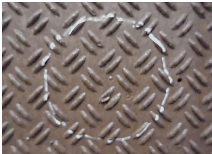
Abbildung 7. Typischer Oberflächenzustand nach Schlageinwirkung
