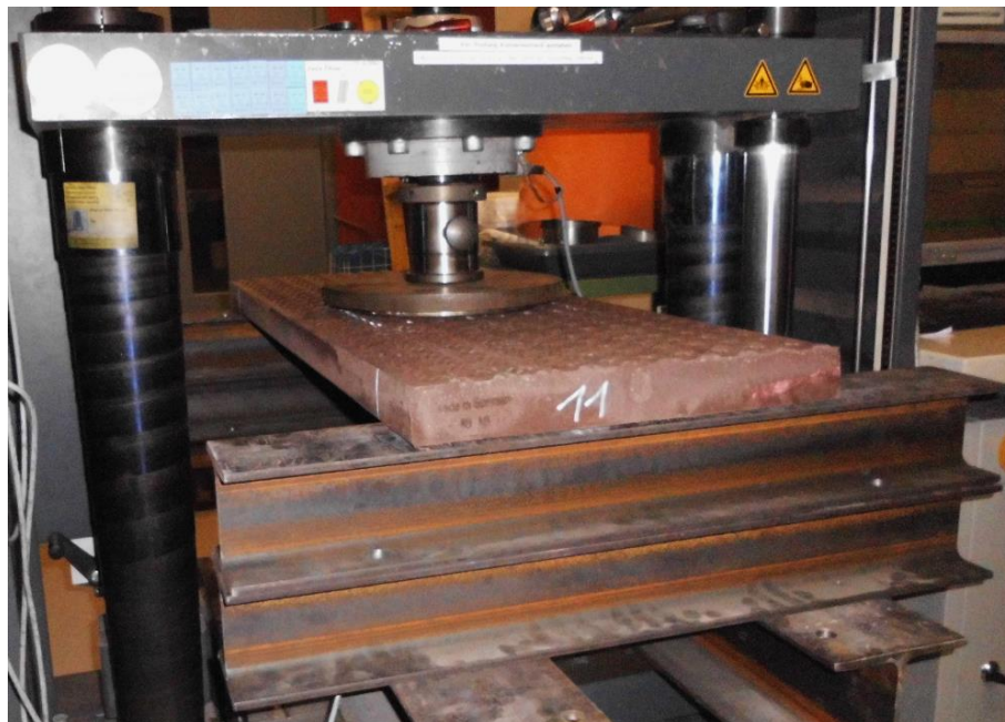
Abbildung 2. Prüfaufbau Bleibende Verformung und Tragfähigkeit
